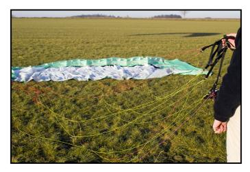
... suite "Démélage des suspentes 1.4"... Leçon qui commence avec une "demie-aile" et ses élévateurs gauche, mais qui peu aussi commencer par la "demie-aile" droite...Prendre par l'extrémité le paquet d'élévateurs gauche avec la main droite...
