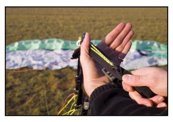
... placer la main sous les d'élévateurs à environ 20 cm de leurs extrémités en prenant bien garde qu'il n'y est pas de "tours de sellette" et en plaçant l'élévateur "A" au-dessus des tous les autres (voir fiche 1.4)...
