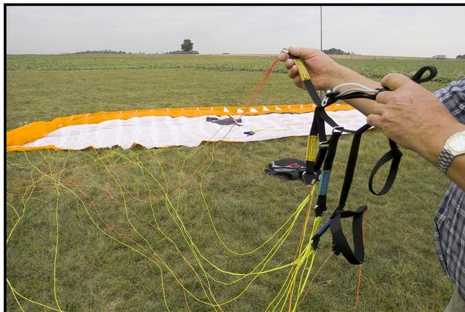
... d'une main tenez l'extrémité des d'élévateurs. Aidez-vous, si nécessaire, avec l'autre pour tourner le paquet d'élévateurs de façon à diriger les "A" vers le haut sans pour autant qu'il croise les autres...
