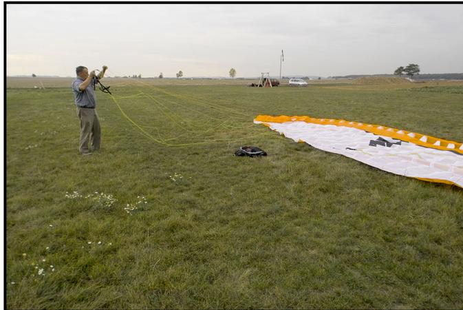
... suite "Positionner la sellette 1.3"... il y a obligatoirement sur toutes les ailes deux paquets d'élévateurs. Par l'intermédiaire de suspentes chaque paquet est relié sous l'intrados du parapente, l'un à gauche ou l'autre à droite de l'aile. Choisir l'un des paquets en laissant l'autre par terre et tendez les suspentes sans faire bouger la voile sur le sol ...
