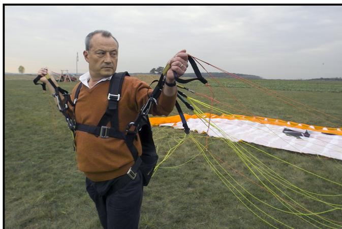
...et le deuxième mot **A** pour toujours vérifier si les A gauche sont bien au dessus des autres élévateurs ....
